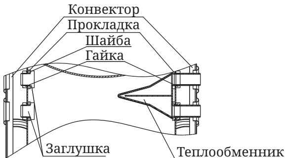
Рисунок 9. Демонтаж теплообменника
