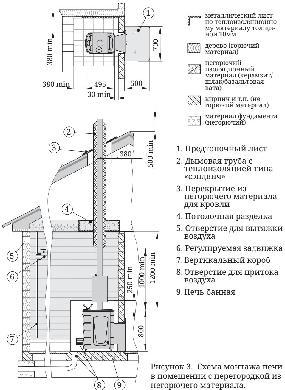
Рисунок 3. Схема монтажа печи в помещении с перегородкой из негорючего материала.
